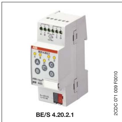
Der 4fach Binäreingang BE/S 4.20.2.1 mit manueller Bedienung ist ein Reiheneinbaugerät zum Einbau in den Verteiler. Das Gerät ist zum Erfassen von potentialfreien Kontakten geeignet. Die gepulste Abfragespannung wird intern erzeugt.
